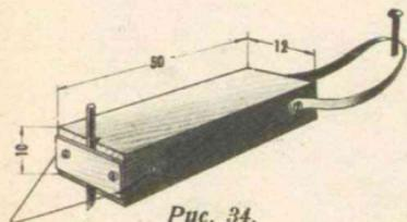
Прежде чем приступить к разметке диска, нужно сделать специальный циркуль для вычерчивания спирали (рис. 34). С одной стороны бруска вырезывается небольшое углубление для грифеля карандаша. Удерживается грифель полоской картона или кожи, прибитой двумя маленькими гвоздиками. С боков бруска прибейте концы петли из тонкой медной проволоки.
